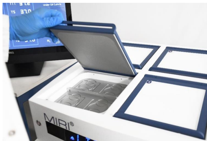
Figura 22.1 Placă de optimizare a încălzirii în interiorul incubatorului FIV cu camere multiple MIRI®
