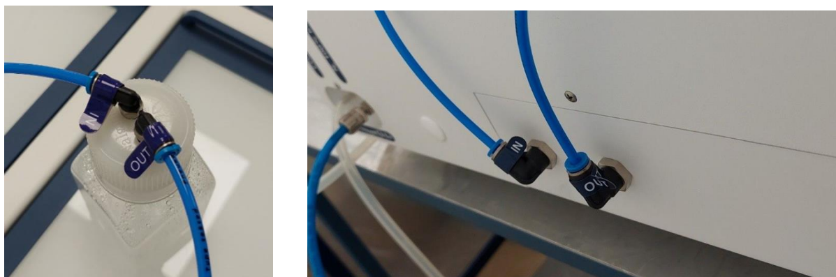
Figura 23.1 Conectarea tubului pe flaconul de umidificare și incubatorul FIV cu camere multiple MIRI® Humidity
