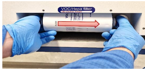
Figura 12.2 Procedura de introducere și îndepărtare a filtrului COV/HEPA
